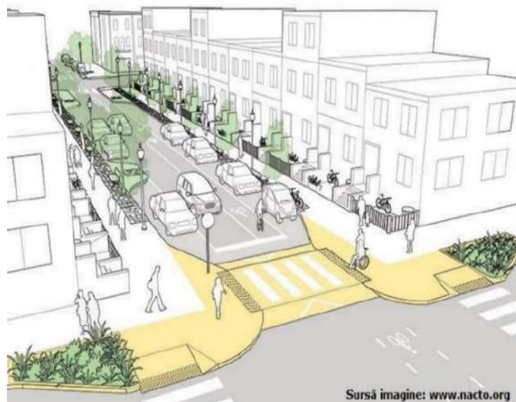
Figură 9-51 - Exemplu amenajare intersecții străzi tip „home-zone”
